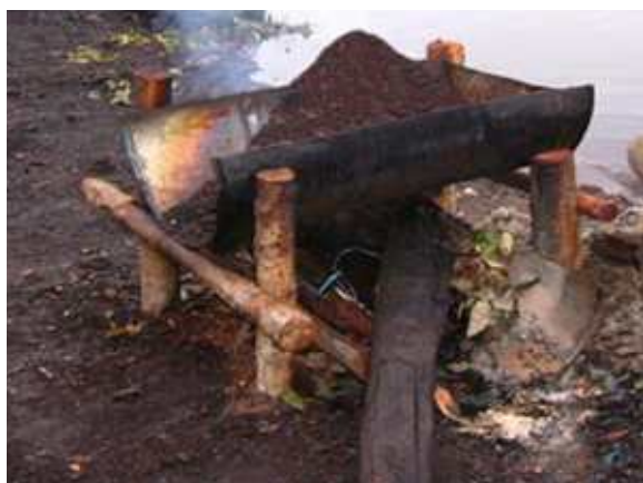
Gambar 6. Pembuatan abu bakar di atas potongan drum
